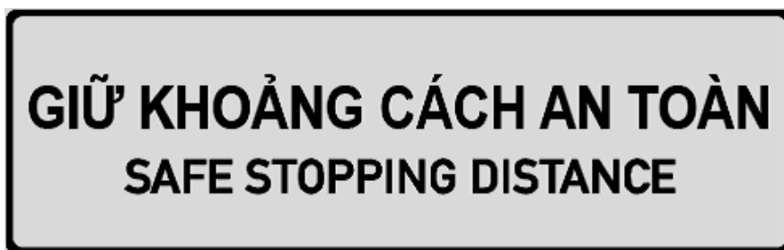
Hình 30. Biển số IE.471 chỉ dẫn giữ khoảng cách lái xe an toàn
