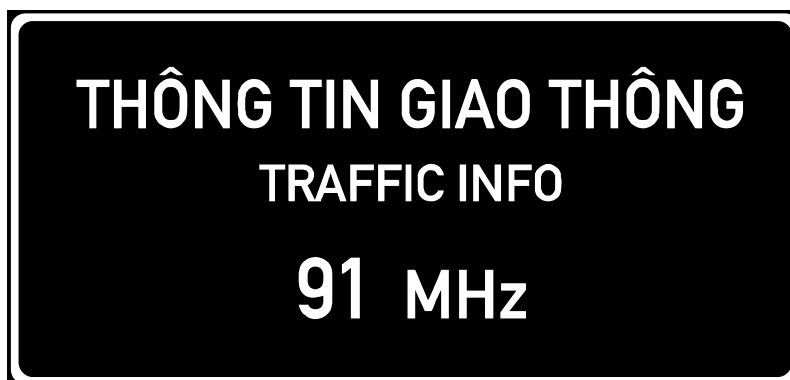
Hình 21. Biển số IE.462 chỉ dẫn tần số trên sóng radio
