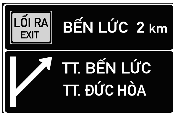
Hình 11. Biển số IE.454 chỉ dẫn khoảng cách đến lối ra phía trước Tại lối ra, đặt Biển số IE.464b tại dải phân ngã ba của nhánh rẽ
